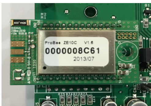
[그림 7] 페수 배출 자동기록 모니터링 시스템의 Zigbee 통신부
