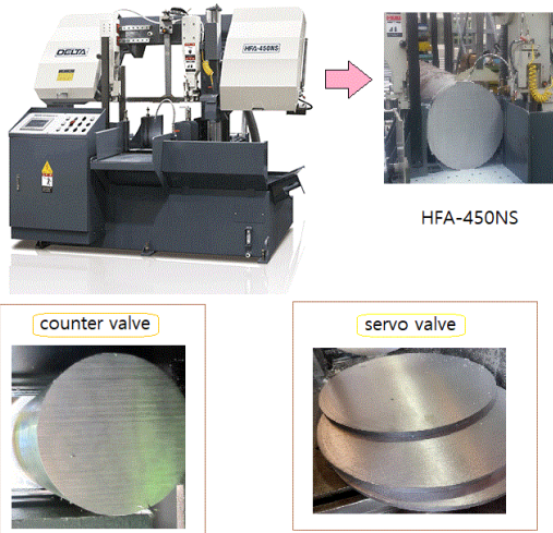
[그림 5] 카운터 밸브와 유압서브 밸브 방식의 시험·비교
