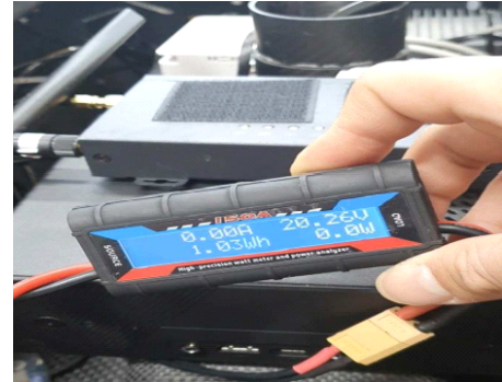
[그림 8] 리튬이온기반 해양특화전지 사용전력측정
