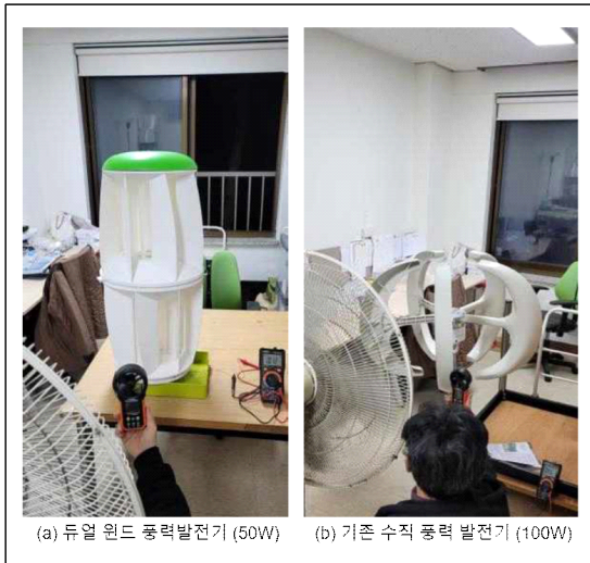
[그림 6] 듀얼 소형 풍력 발전기 풍량 비교 테스트
