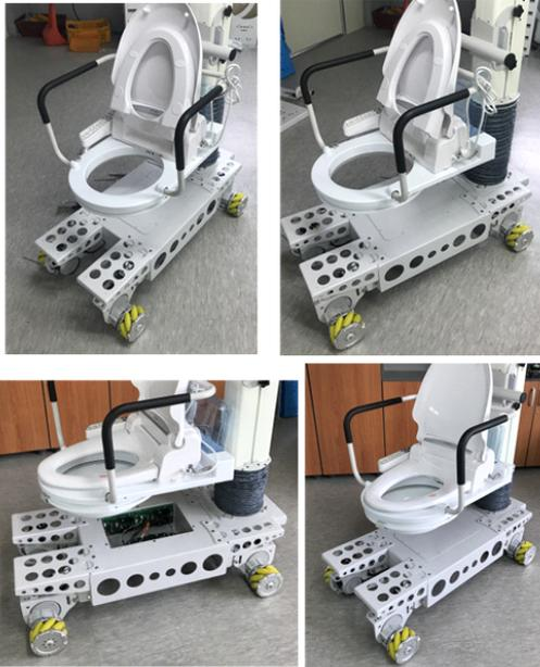
[그림 6] 중증 환자 및 요양환자용 배변 리프트 외관
