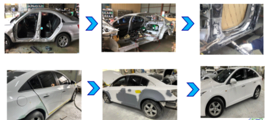
(Fig2: 파손차량 수리 작업)
