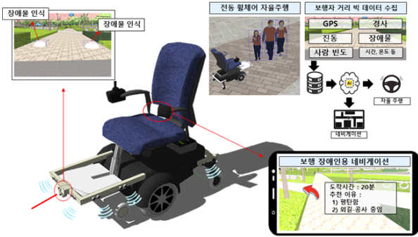
[그림 1] 보행 장애인을 위한 스마트 시스템 구성도
