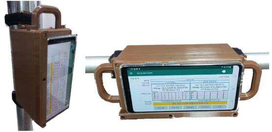
[그림 2] 내압 및 잔압이 있는 파이프 이상 여부 진단 시스템 설치 모습
