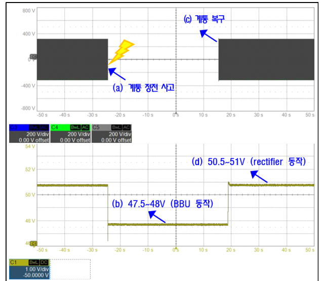
[그림 10] 계통 사고 및 복구 시 rectifier -BBU 전환 동작 특성 결과
