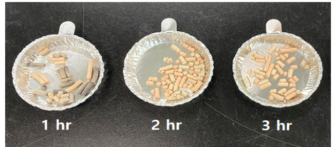
[그림 4] 소성 시간에 따른 알루미늄 실리케이트 흡착 시료의 모습
