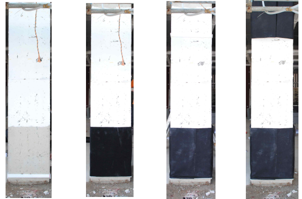
a. 하단 우드락 설치 b. 하단 벨크로 결합 c. 상단 우드락 설치 d. 상단 벨크로 보강
