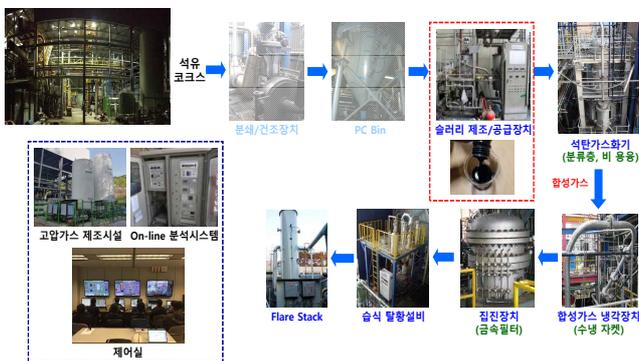
[그림 1] 1~2 톤/일급 가스화시스템 공정 구성
