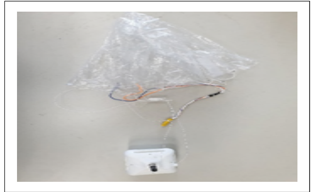
[그림 3] 낙하산 및 보드, 안테나를 장착한 음향인식 디바이스
