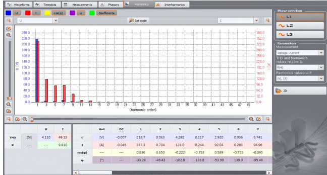
[그림 3] A 건축물 변압기 2차 측의 전류 고조파 스펙트럼
