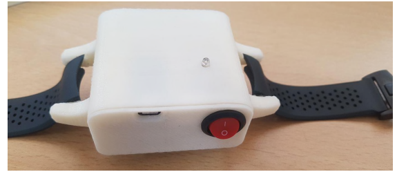
[그림 7] 적외선 엘이디를 이용한 웨어러블 약물주입기
